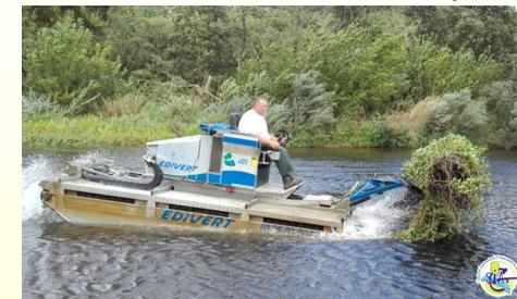
Arrachage mécanique avec un véhicule amphibie
