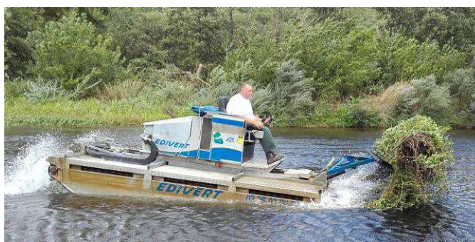
Véhicule amphibie utilisé sur la Gartempe aval pour l'arrachage mécanique
