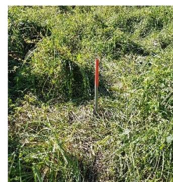
*Piezomètre installé dans la zone humide à proximité de la Loire à Coussay-les-Bois*
